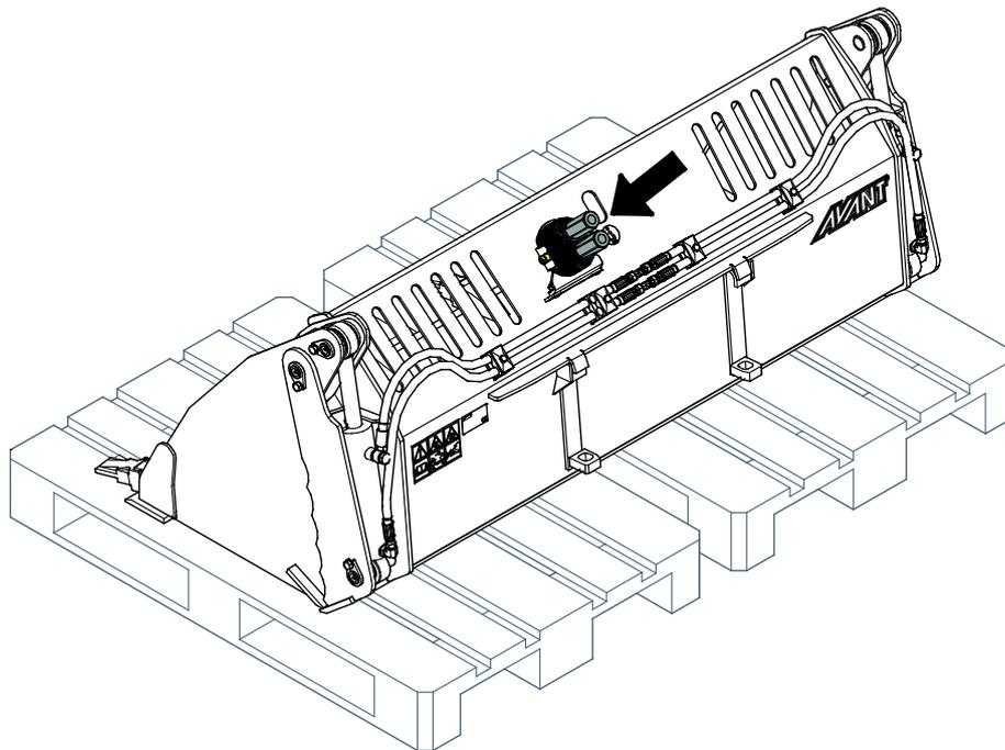
Limpe o acessório antes de longos períodos de armazenamento retoque a pintura sempre que necessário, lubrifique os pontos de lubrificação e coloque óleo nas partes visíveis dos eixos do cilindro hidráulico para evitar ferrugem.
